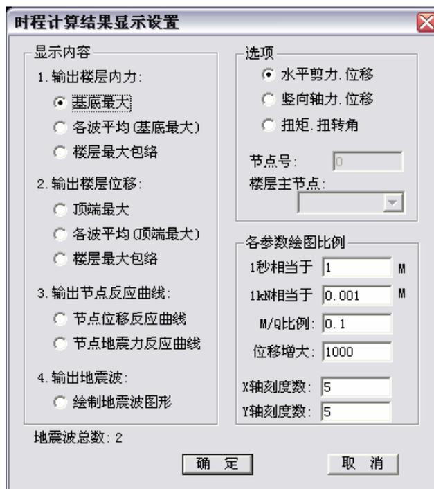
对话框左侧**图形内容**组合框中列出了四类时程计算结果：楼层内力、楼层位移、节点反应曲线、地震波。
