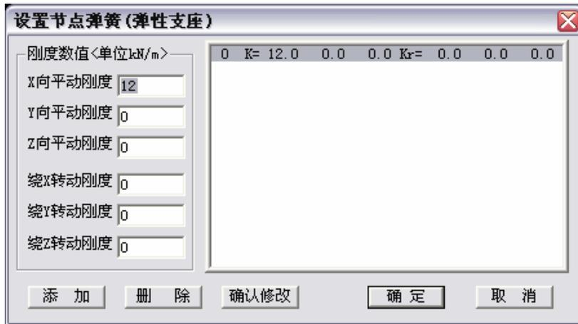
节点弹簧用“K=”引导数值表示。字符K之前为节点弹簧在列表中的序号，K之后的第一行为平动刚度，第二行为转角刚度。是否显示节点弹簧在图形内容(🖥️)对话框中通过**节点弹簧**选项控制。当运行节点弹簧命令时，该选项被自动选中，并在选择梁柱单元之前重绘图形。显示节点弹簧需节点单元处于被显示状态。
