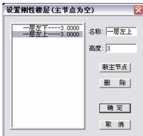
第一次启动对话框时，隐含一个空主节点，但名称为空、高度为 0.0。直接在**名称**框内输入自定义的名称，名称可以是字母、数字、或汉字，不超过 12 个字符(6 个汉字)。然后在**高度**框内输入该主节点的高度坐标Z值。注意主从节点的高度坐标必须相同。被输入的名称、高度即时在列表中显示。
