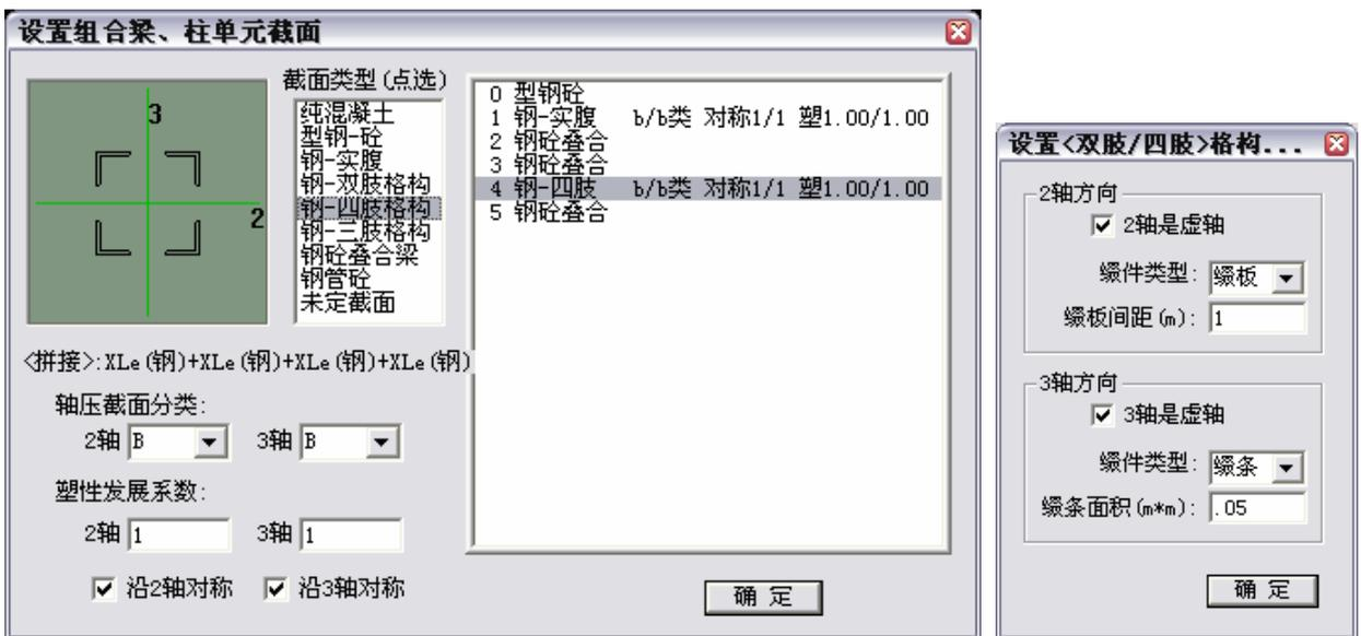
如选择截面类型列表中的**双肢格构**、**四肢格构**、**三肢格构**，将弹出格构构件参数设置对话框，如上图右侧所示。如一个轴不为虚轴则该轴为实轴。如为虚轴，则需进一步选择缀件类型，并输入缀板的间距，或缀条的面积。如 2、3 轴均不为虚轴，则等于设置为实腹截面。
