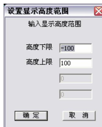
非楼层控制时, 将弹出上边右侧对话框, 输入显示高度的上限、下限。
