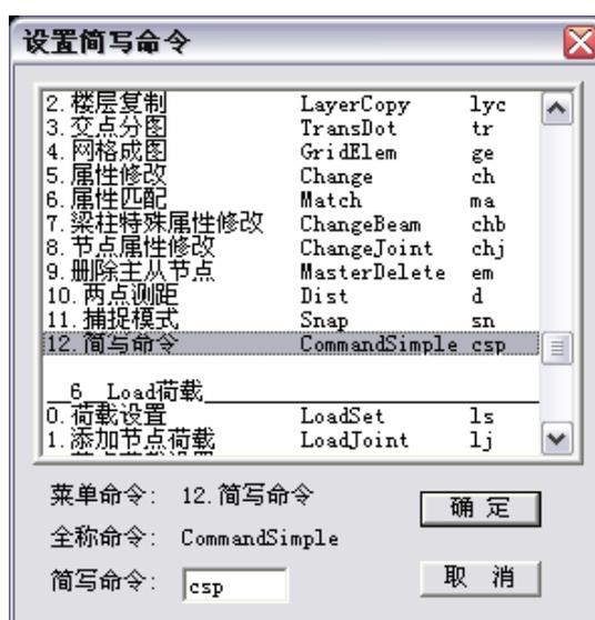
对话框列表中按系统主菜单的顺序列出各操作命令的菜单命令、全称命令和简写命令。点取列表中的一行，三个命令的名称显示在对话框底部相应的位置。
