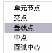
在 XY 平面、切面显示状态下，如未捕捉到节点，将按实际鼠标点击点作为输入点。在三维立体显示状态下，如未捕捉到节点，将被视为无效输入，需重新鼠标输入或改用键盘输入坐标值。
