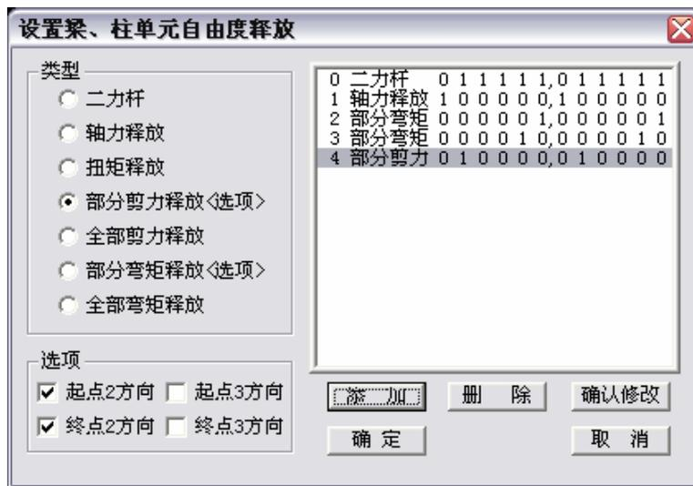
**二力杆**。仅保留单元轴向刚度，其它 10 个自由度释放。用于网架、铰接桁架、铰接支撑。
