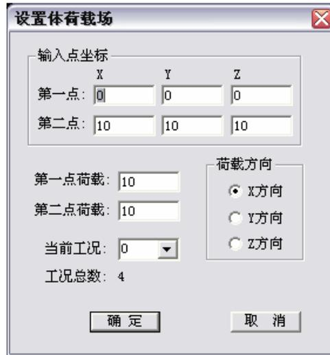
体荷载场由空间两点的荷载值定义，块体元各角点向两点连线作垂点，由垂点坐标在两点的荷载值间差值确定该角点的荷载数值。
