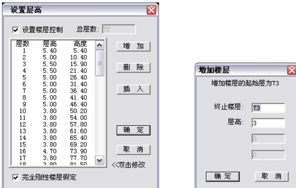
对话框左侧为楼层列表，显示楼层号、楼层层高、各楼层面的高度。楼层从 Z=0.0m 高度开始。0 层作为一个特殊的楼层，其高度总为 0.0m，
