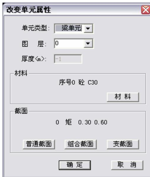
对话框中显示被选则单元的属性。根据被选择单元情况，各控件显示状态不同。
