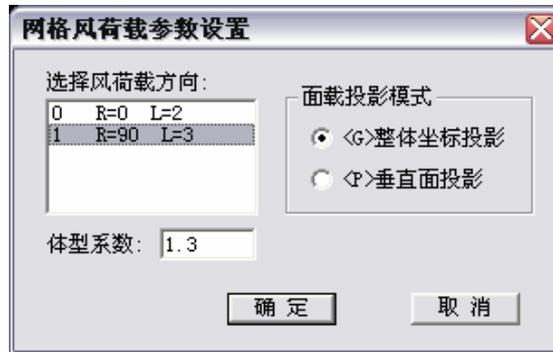
对话框右上角为设定的风荷载列表，可鼠标选择列表，改变当前风荷载工况。**体型系数**框内输入本次导算的体型系数。
