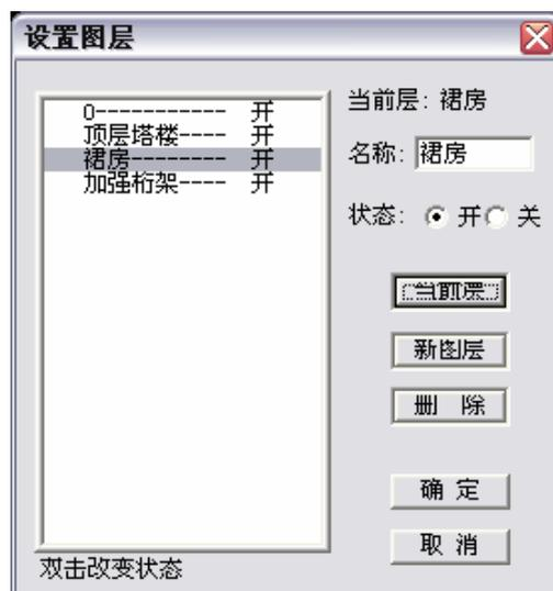
点击**新图层**按钮将在列表出现一个新行，输入图层名。图层可以是数字、字母、汉字，不超过 12 个字符(6 个汉字)。点删除将删除列表中的当前选择项，除非是新生成的图层，已经被使用的图层不能
