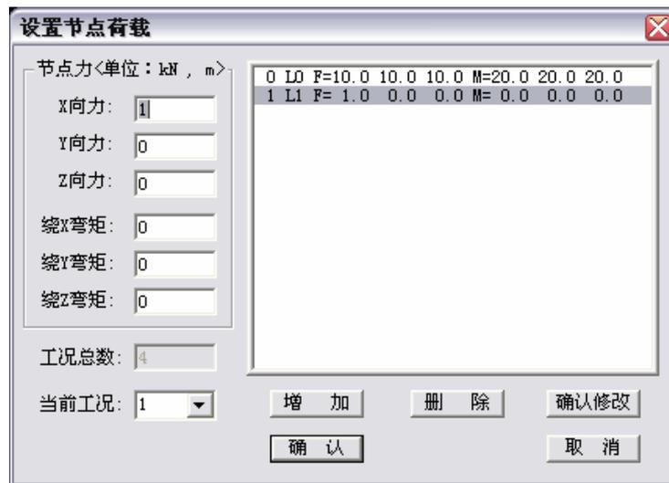
点**确定**退出对话框后，所在行颜色被加深的节点荷载即为新的当前节点荷载。如在运行节点加载命令过程中调用该对话框，则当前荷载被显示在屏幕的左上角。下一次节点加载即采用该当前节点荷载。
