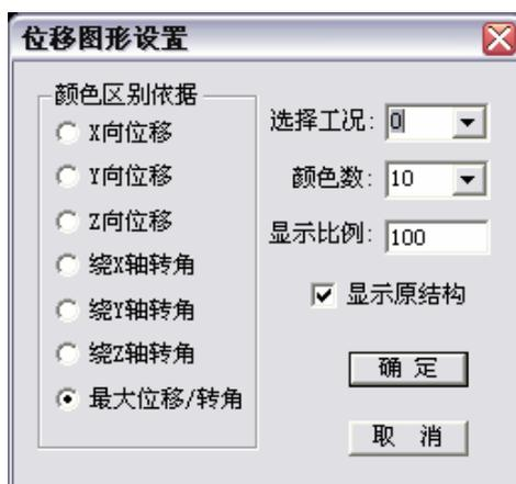
**显示比例**指显示位移量的增大比例，可以输入合适的值查看各部分的位移。选中**显示原结构**选项时，将用灰颜色显示未变形的结构轮廓。
