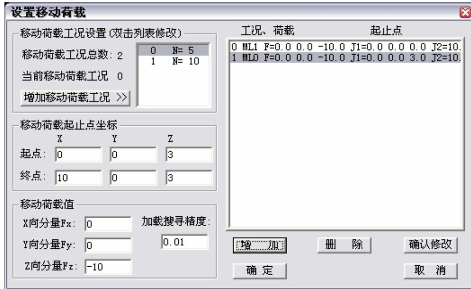
对话框左上角组合框设置移动荷载工况。点**增加移动荷载工况**按钮，将弹出一个对话框输入该移动荷载工况的计算点数，计算点数不小于2，退出对话框后该工况即显示在列表中。双击列表中的某一工况，可修改输入的计算点数，如修改后的计算点数小于，则该移动工况被删除。列表中颜色被加深的行为当前移动工况，可鼠标选择改变。
