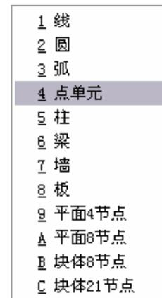
除用弹出菜单设置选择过滤外，多数操作具有自动过滤功能，尤其是针对某些单元的属性操作。如输入线单元分布荷载时，则自动过滤掉其它面、体单元，如在命令行中输入选项只针对梁或柱输入，则另外的线单元也被过滤。
