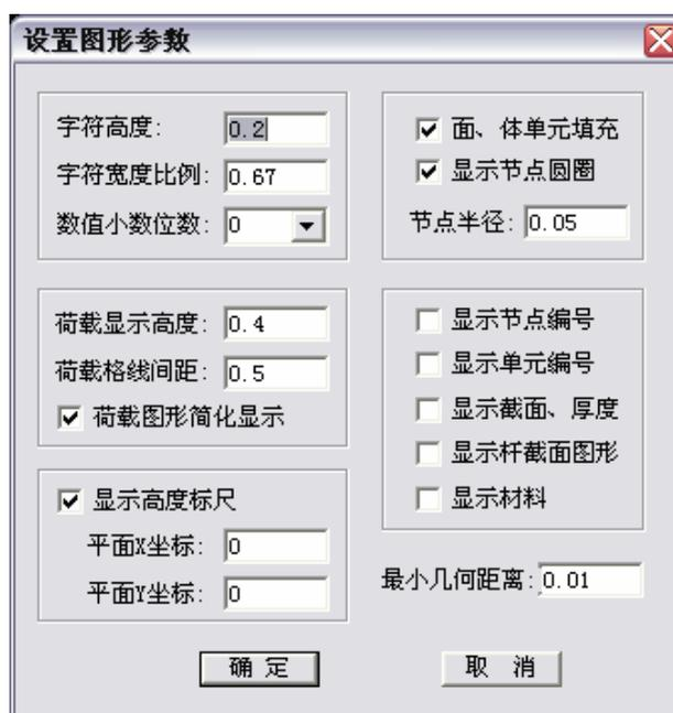
**面体单元填充**选项被选中时，墙、板、平面、块体单元将填充显示，否则只显示单元边线轮廓。
