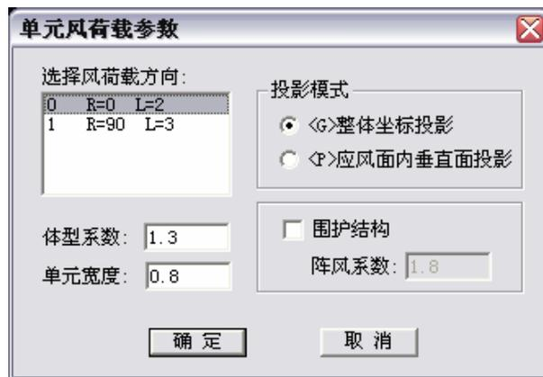
对话框右上角为设定的风荷载列表，可鼠标选择列表，改变当前风荷载工况。体型系数框内输入本次导算的体型系数。单元宽度框内输入单元构件在迎风面上的投影宽度，对于平面结构导算侧向风荷载时，需输入结构平面外的受荷宽度。
