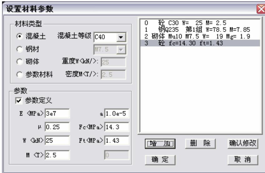
系统隐含一种混凝土材料，为 C30 标准混凝土，开始一个新工程时该材料即为各输入图形单元的当前材料，如不需该材料可修改。系统容许输入 50 种各类型材料。
