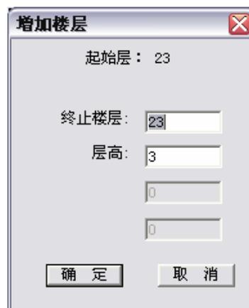
如取消对话框中**设置楼层控制**选项，则不使用设置的楼层进行显示控制，而直接用高度Z坐标的控制显示的高度范围。楼层控制、非楼层控制时各项视图命令的操作有所不同，将在各项命令中分别讲述。隐含非楼层控制时的高度范围为Z=-100.0~100.0m。
