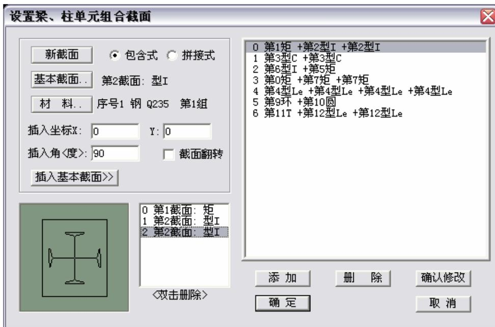
组合截面分包含式、拼接式两类，通过选择对话框左侧顶部的相应选项设置。
