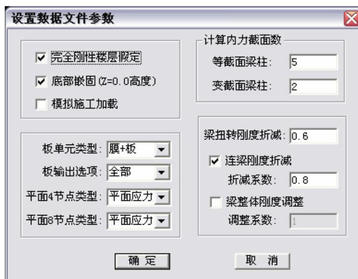
**板输出选项**有关板单元最终计算结果的输出。如选中下拉框中的**应力**选项，则只输出板的节点应力。如选中**节点力**选项，则只输出板的节点力，而不输出节点应力。如选中**全部**选项，则节点应力、节点力均输出。
