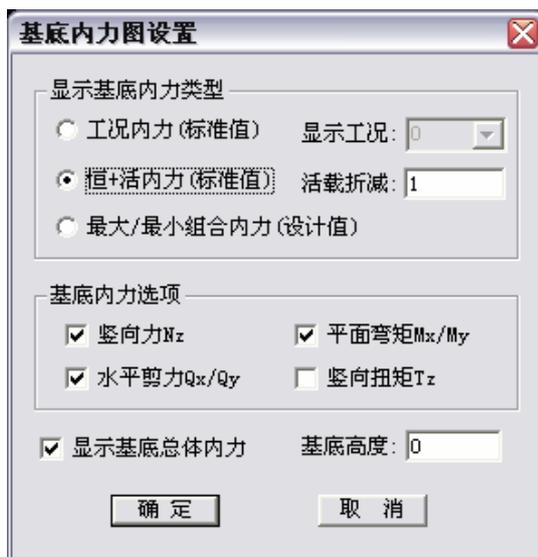
选择**最大/最小组合内力(设计值)**，将显示柱、撑、墙等基底截面的组合内力包络值。须注意墙基底内力包络值的定义方式。
